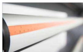
Scala millimetrata su ogni albero per il corretto posizionamento del materiale
