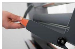
Piano di lavoro anteriore in acciaio e basculante per settaggio veloce delle bobine
