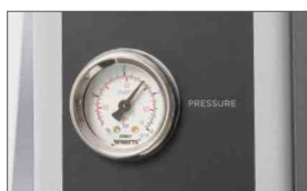
Manometro per visualizzare la pressione del rullo superiore
