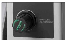
Regolatore di pressione del rullo superiore
