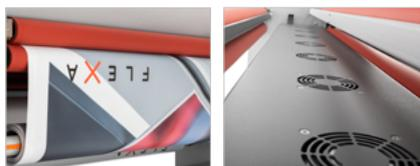
Rulli posteriori di trazione con sistema di raffreddamento forzato per incapsulazione a caldo, stampe laminate a caldo e stesura biadesivo (optional)
